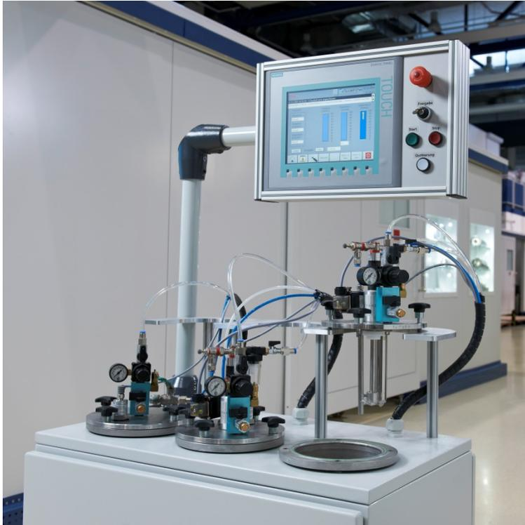
Foto: Drei-Druckbehältersuspensionsförderer zum Thermischen Spritzen
