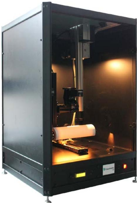
**imanto® obsidian** – Messsystem zur hyperspektralen Inspektion von Oberflächen und Schichten
