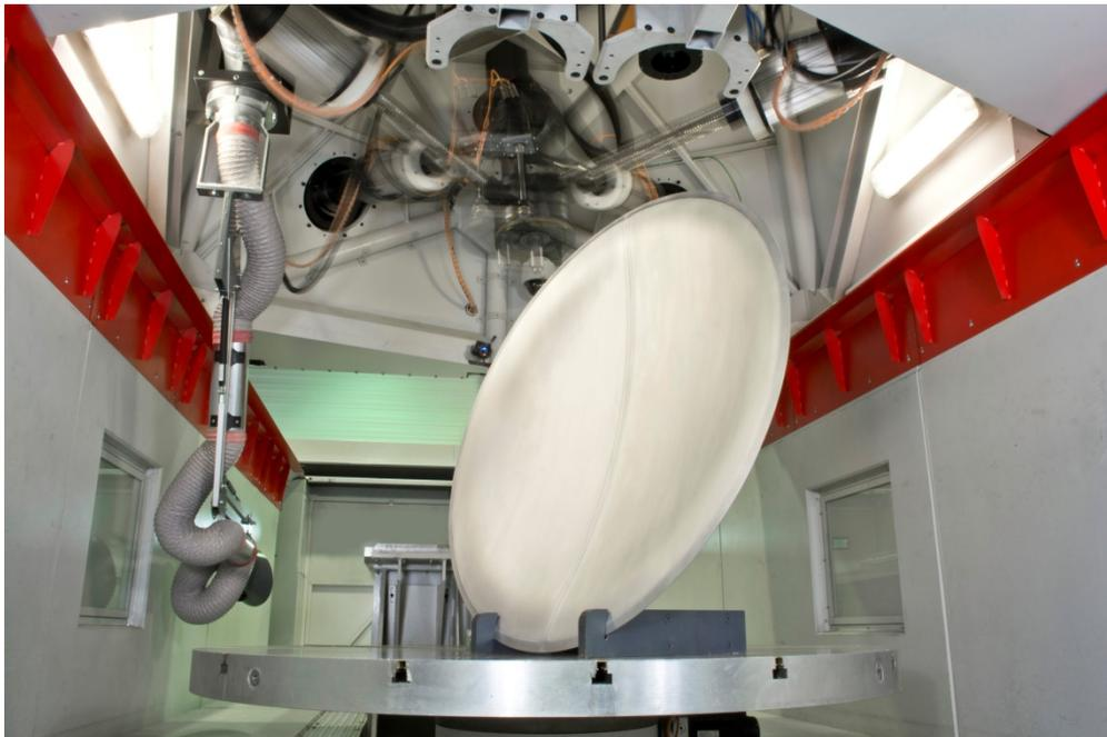
**Demonstrator: Ronde mit mittig flach geschweißter FSW-Naht.**
