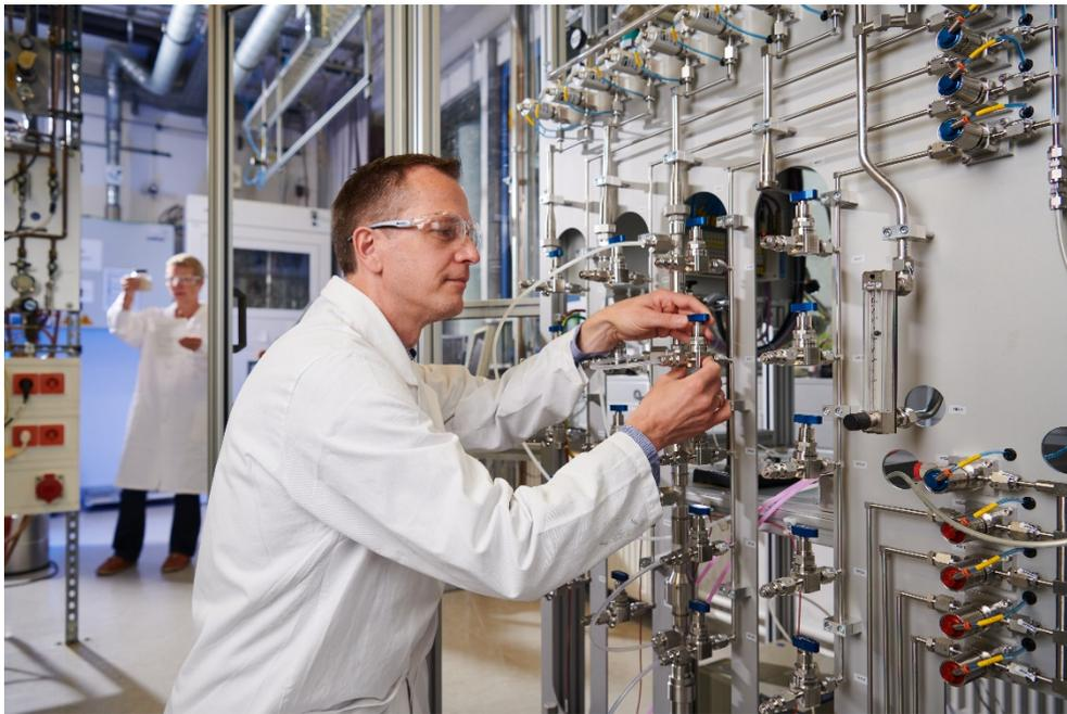
**Um die geeigneten Filtersubstanzen zu finden, nutzen die Forschenden des Fraunhofer IWS eine Multi-Adsorptionsanlage, womit das Adsorptionsverhalten gleichzeitig konkurrierender Gase untersucht wird.**
