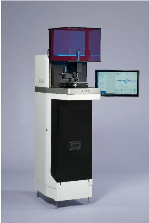
Die eigens entwickelte Software mit ihrer intuitiven Benutzeroberfläche steuert die Messung und ermöglicht eine reproduzierbare und automatisierte Auswertung anhand eines definierbaren Messrezepts.
