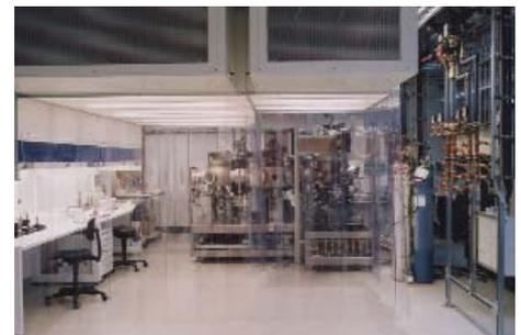
Anlage zur Abscheidung von Nanometermulti-schichten auf Großflächen
