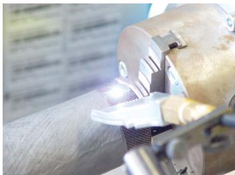
Abb. 2: Lasermikroperforationsprozess an einem Produktionsmuster
