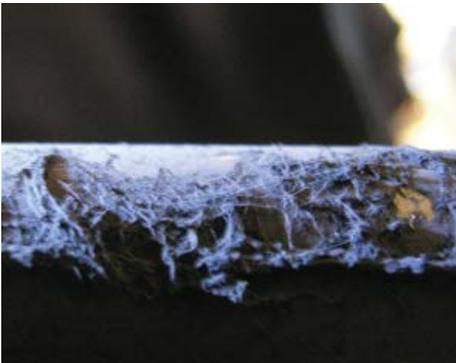
Abb. 1: Makroskopische Netze, bestehend aus Bündeln von Kohlenstoff-Nanoröhren
