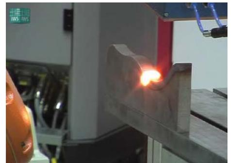
Abb. 3: Simultan durchgeführter Härteprozess
