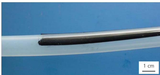
Abb. 3: Geplottete Elektrode aus leitfähigem Silikon (schwarz) auf einem Polymersubstrat (hell)
