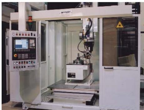
Laserstrahlschweißanlage mit 6 kW-CO<sub>2</sub>-Laser
