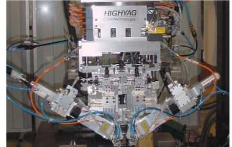
Abb. 1: Schweißkopf mit integrierter Stringerspanntechnik zum **beidseitig-gleichzeitigen** Schweißen von Stringer-Haut-Verbindungen
