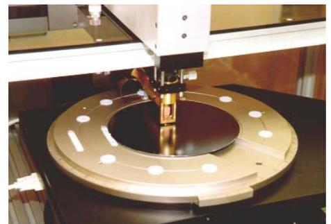
Abb. 2: Laserakustische Messapparatur zur Prüfung von Bearbeitungsrandschichten in Halbleiterwafern
