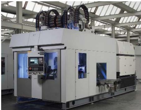
Anlage zum Laserinduktionsschweißen von Hohlwellen (oben) und Schweißprozess (unten) bei GETRAG Neuenstein (Hersteller: EMAG Laser Tec)
