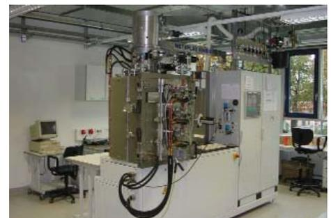
Anlage zur Abscheidung von nitridischen Hartstoffschichten
