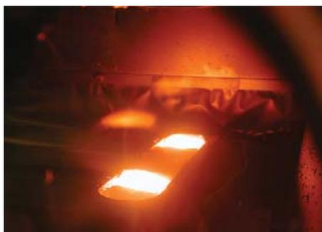
Metallverdampfung mittels Elektronenstrahltechnologie
