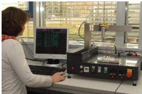
Abb. 1: Dosier- und Plottgerät zum Aufbau von 3D-Scaffolds
