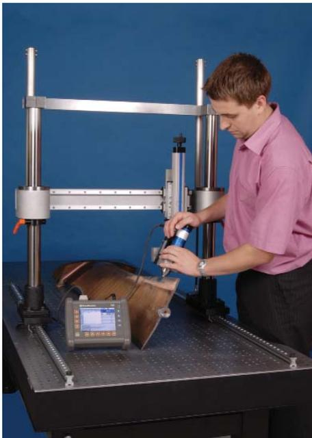
Abb. 1: Härteprüfung an einer laserstrahl-gehärteten Eintrittskante einer Dampfturbinenschaufel
