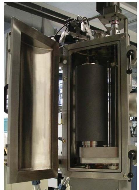
Abb. 2: LAM-Kammer mit Kohlenstoffkathode
