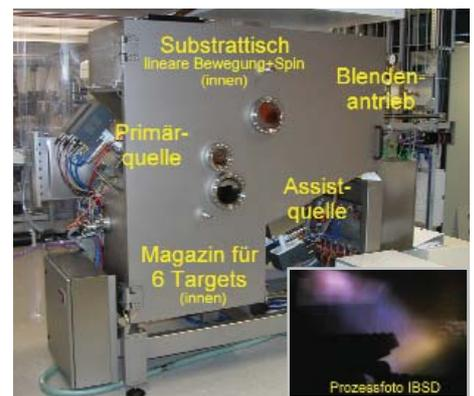
Abb. 3: Ionenstrahlsputterbeschichtungsanlage »IonSys 1600«
