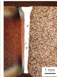
Abb. 1: Vergleich von laserstrahlgeschweißten Mischverbindungen aus Gusseisen und Einsatzstahl
