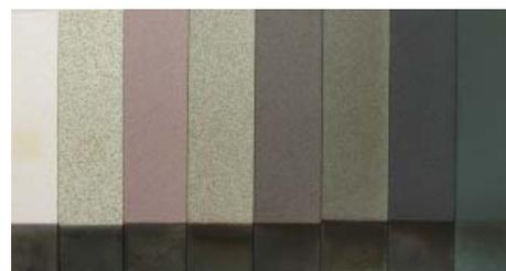
Abb. 2: Färbung durch unterschiedlichen  $\text{Cr}_2\text{O}_3$ -Gehalt
