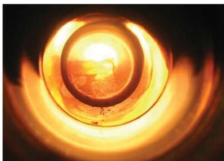
Arc-Synthese von Fäden aus Kohlenstoff-Nanoröhren
