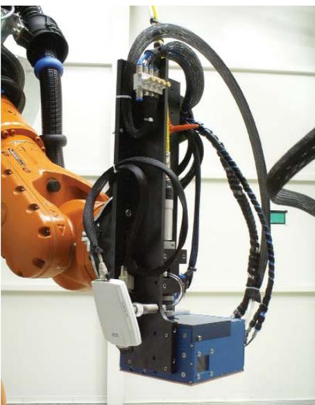
Abb. 2: Laseroptik »LASSY« montiert an Roboter
