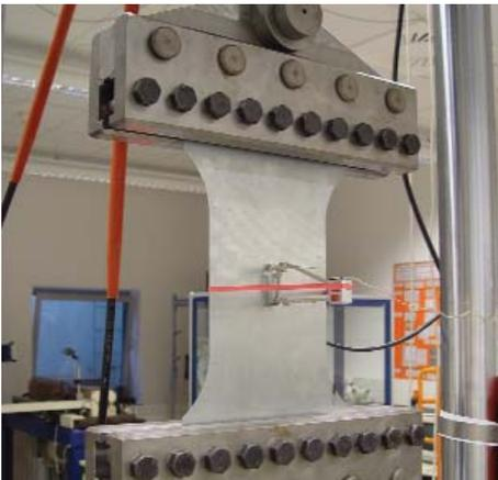
Abb. 2: Probe während des Vorverformens durch Recken in der Zugprüfmaschine MTS 810
