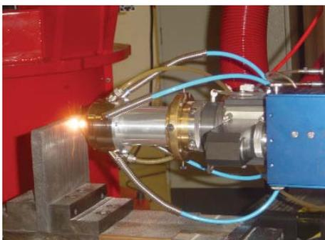
Abb. 2: Segmentierte Pulverdüse zum Auftragschweißen in Zwangslagen
