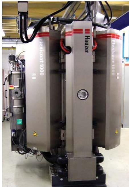
FlexiCoat 1000® Beschichtungsanlage der Firma Hauzer Techno Coating mit integriertem Laser-Arc-Modul LAM400
