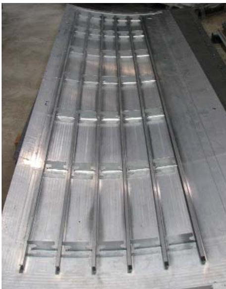
Abb. 2: Beispiel für ein laserstrahlgeschweißtes Hautfeld mit Stringern und Clips
