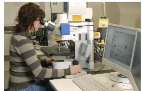
Laserscanning-Mikroskop LSM Pascal 5 zur hochpräzisen Charakterisierung und Analyse von Oberflächen im Mikro- und Nanometerbereich
