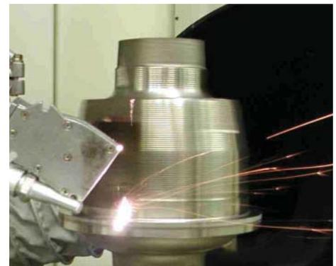
Industrielle Umsetzung des Laserstrahlreinigens von Fügstellen für nachfolgendes Laserschweißen, ermöglicht Ersatz von Waschprozessen
