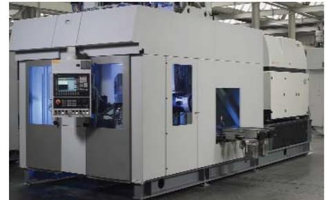
Laseranlage zum Laserstrahlreinigen und -schweißen im Industrieinsatz
