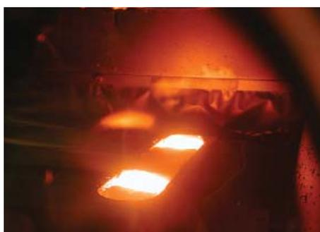
Metallverdampfung mittels Elektronenstrahltechnologie
