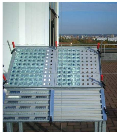
Abb. 2: Freibewitterungsstand mit Zylinderprüfkörpern (oben) und Druckscherprüfkörpern (unten)
