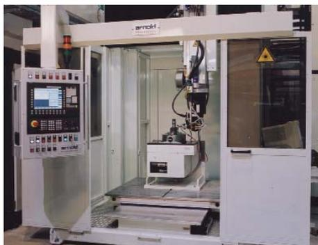
Laserstrahlschweißanlage mit 6 kW-CO<sub>2</sub>-Laser
