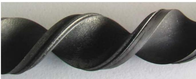
Abb. 3: Walzplattiertes Band, Ansicht nach Tordierung
