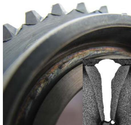
Abb. 2: Carbonitriertes Bauteil nach kombiniertem Abtrag- und Schweißprozess
