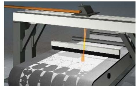
Abb. 2: Anlagenprinzip des Remote-Laserstrahlschneidens »on the fly«
