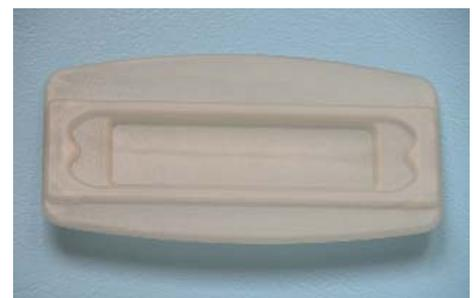
Abb. 4: Spritzgussteil, hergestellt mit einem Werkzeugeinsatz gemäß Abb. 3
