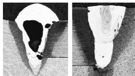
Abb. 1: Lasergeschweißtes Bauteil mit nitriertem Lenkrohr (oben) und Querschliffe von Schweißnähten
