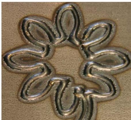
Abb. 2: Laser-Konturauftragschweißung mit zentrischer Drahtzufuhr (1,3 mm Raupenbreite)
