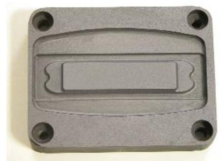
Abb. 3: Fertiger Werkzeugeinsatz nach Herauslösen des Positivmodells und Endbearbeitung
