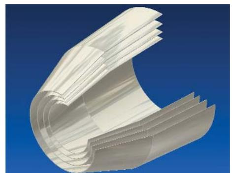
Abb. 3: Schematische Darstellung einer Wolter-Typ-1-Optik zur Fokussierung von EUV-Strahlung
