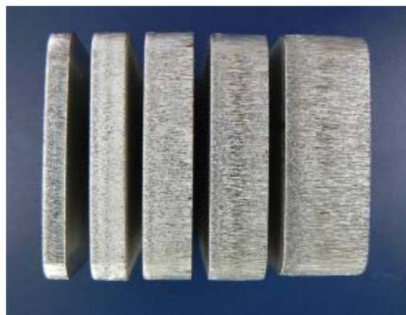
Abb. 3: Schnittkantenqualität von Aluminium-, (links, Materialdicke 4 - 12 mm) und Edelstahlproben (rechts, Materialdicke 4 - 15 mm)
