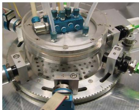
Abb. 3: Modellreaktor mit Gasbereitstellungssystem und rotierender 3-Kanal-Sensoranordnung
