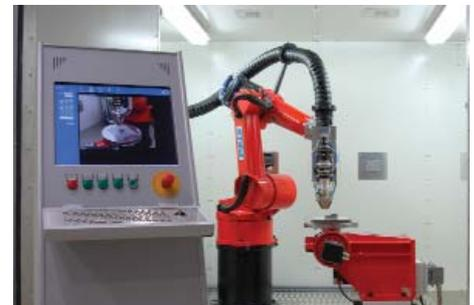
Roboteranlage mit 6 kW-Laser zum Laser-auftragschweißen
