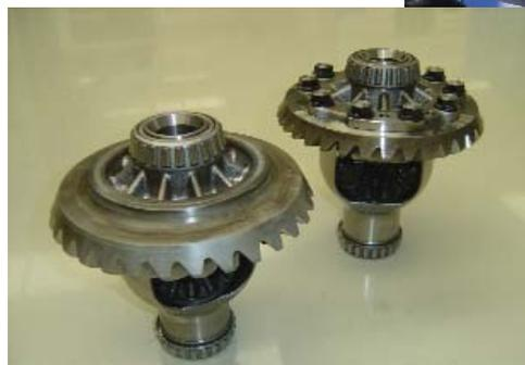
Prozesskettenverkürzung durch Laserstahlschweißen mit Zusatzwerkstoff und Ersatz aufwändiger Schraubverbindungen, links: Beispielbauteile, rechts: Laserschweißprozess
