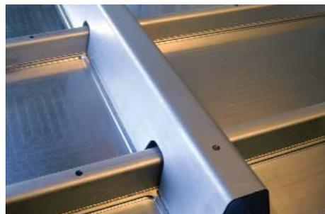
Vollständig lasergeschweißte Integralstruktur für Flugzeugrümpfe in geschlossener Profilbauweise (Demonstrator)
