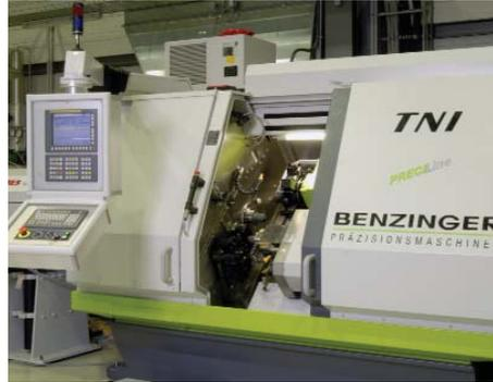
Integration des Laserstrahlhärteprozesses in eine Drehmaschine - Beispiel: Hydraulikkomponenten für Bosch-Rexroth
