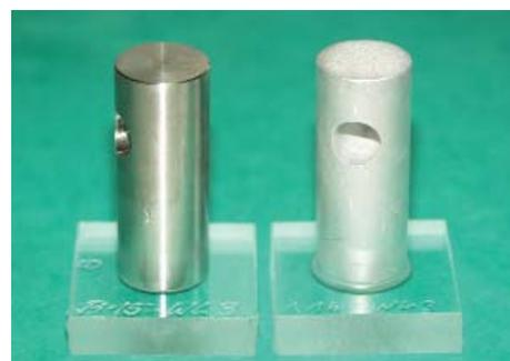
Abb. 1: Zylinderzugprüfkörper Glas / Metall
