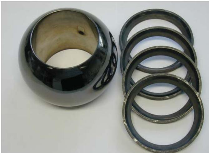
Abb. 2: Kugel und Lagersitze eines Kugelventils
