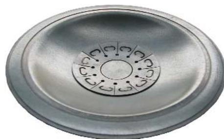
Abb. 1: Umgeformtes Modellteil mit optimierter Patch- und Schweißnahtkontur
