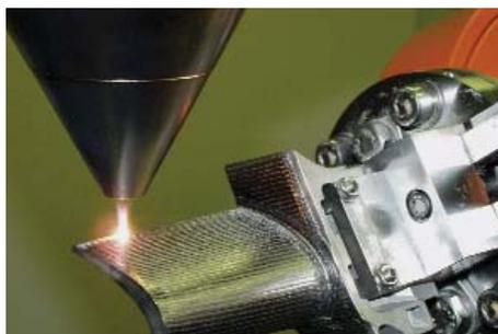
Reparatur von Gasturbinenschaufeln durch Auftragschweißen mit Hochleistungs-Diodenlaser
