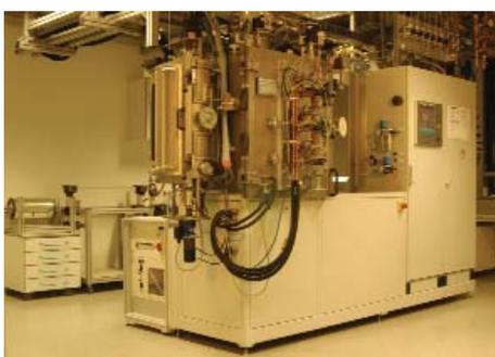
Anlage zur Abscheidung von superharten diamantähnlichen Kohlenstoffschichten (Diamor®) nach dem Laser-Arc-Verfahren
