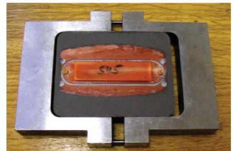
Abb. 2: Hinterfütterter Schichtverbund im Gießrahmen
