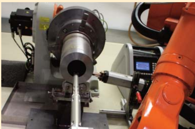
Schweißaufbau zum induktiv-unterstützten Innenrohr-Auftragsschweißen
