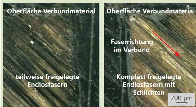
Erscheinungsbild von teilweise und komplett freigelegten Endlosfasern in PP Matrix nach der Laserbearbeitung
