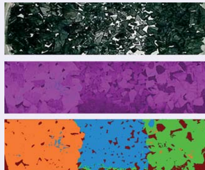
Foto der Probe (oben), Ausschnitt der hyperspektralen Messung bei 650 nm (Mitte) und Klassifizierung (PA6, PA66 und TPU, unten).
