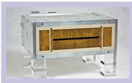
Abb. 1: LARGE Plasmaquelle; kompakte Bauweise für die Adaption an einen Roboterarm
