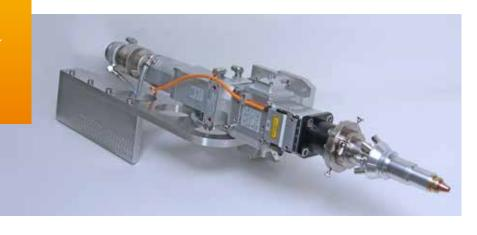
4つの粉末照射ノズルの COAX13 は、長くてスリムなノ ズル本体と、30mmの小さ な干渉輪郭径により、到達が 困難である機能面や深いキャ ビティをコーティングするた めの優れた前提条件を提供 します。特に、不活性ガス雰 囲気のハウジング内で、損傷 したチタン製タービンインペ ラを修理するために使用され ます。積層造形を使用して、 ブリスク、コンプレッサー用 部品、あるいはその他 3D 構 造を再構築できます。COAX12 のように、4つの個別の粉末
