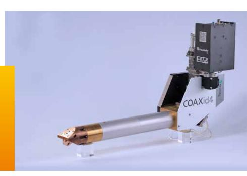
COAXid4は、モジュール式の 内部コーティングユニットで、 ファイバーレーザーまたはディ スクレーザー、さらにはダイオ ードレーザーを用いて複雑な 深い内部輪郭を方向に関係 なくクラッディングできます。 この新しいデザインは、鉄、二 ッケル、銅、コバルトベースの 合金および硬質材料のバイン ダーとの組合せによる、効率 的で高牛産性の内側コーティ ング用に設計されています。 大きな特徴は、粉末チャネル 用の耐摩耗性インサートを備 えた同軸マルチ照射原理に従 って、60°の傾斜角度で設定 されたコーティング用ヘッド です。それにより、止まり穴に
