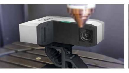
粉末ノズル測定システム Lisec ( [Light Section] より)は、プロセス前に粉末 コーン形状を自動的に測定し ます。そのために、測定レー ザーは、ノズルから出た後の 粉末の流れをスキャンします。 測定平面数は自由に定義でき ます。カメラは、これに対して 直角に取り付けられており、 粉末の光部分を記録し、評価 ソフトウェアに転送されます。 アルゴリズムは、記録された 画像情報を数学的関数と比 較します。そのため、粉末の 流れの3次元的分布を正確
